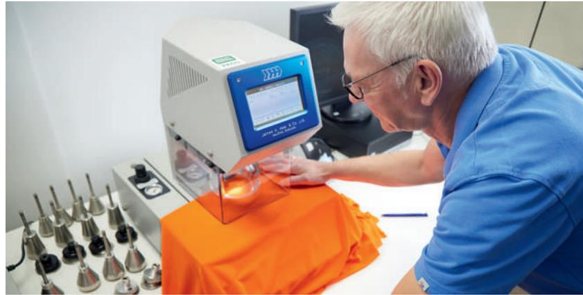
Mit scharfem Blick und einer Technik, die keine Fehler übersieht: Im BP® Prüflabor werden Gewebe und Nähte unter anderem im Drucktest auf höchste Belastbarkeit geprüft.
